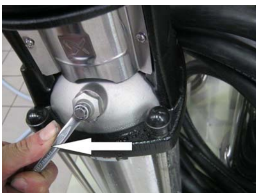
Ryc. 4-3: Zamknięcie śruby odpowietrzającej
