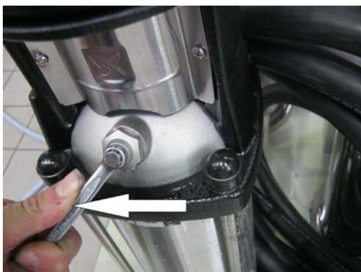
Obrázok 4-3: Zatvorte odvetrávaciu skrutku
