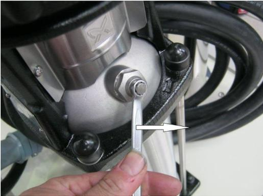
Abbildung 4-1: Entlüftungsschraube öffnen
