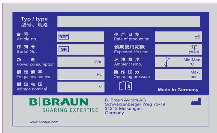
Abbildung 6-1: Beispiel eines Typenschildes
