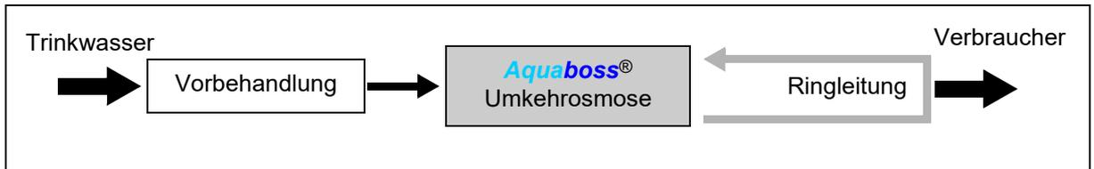
Eine Wasseraufbereitung zum Herstellen von Wasser zur Verdünnung von Hämodialysekonzentraten besteht i. d. R. aus einer Vorbehandlung (z. B. Filter, Enthärter, Aktivkohle...), einer zweistufigen Umkehrosmose
