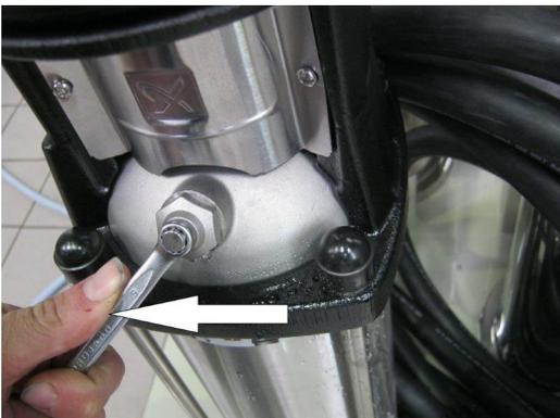
Abbildung 4-3: Entlüftungsschraube schließen
