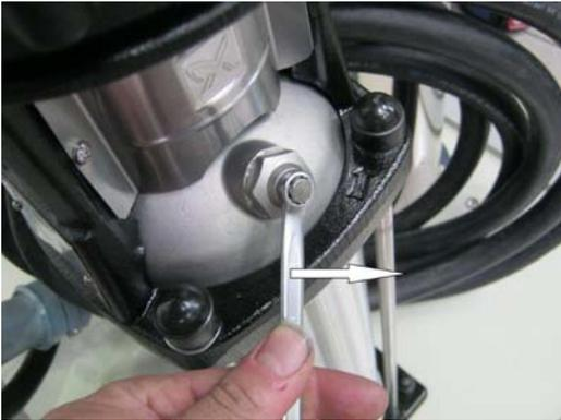
**Abbildung 4-1: Entlüftungsschraube öffnen**
