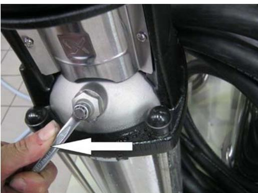
**Abbildung 4-3: Entlüftungsschraube schließen**
